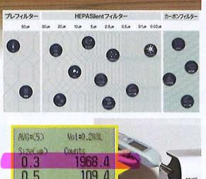
↑カーボンフィルター内蔵の高性能フィルターで菌や化学物質、VOCも除去。測定結果は0.3μmが1968.4個だが、大風量で循環回数を上げれば数値はもっと下がるはず
